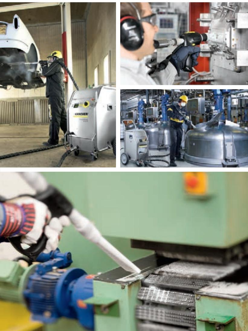
Известно, что очистка станков, деталей и форм часто представляет собой сложную задачу. Обычная пескоструйная или дробеструйная обработка оставляет следы абразивного материала, требующие заключительной уборки. Забудьте об этом – используйте мощные аппараты для струйной чистки гранулами сухого льда, полностью превращающимися в углекислый газ (CO<sub>2</sub>), бесследно улетучивающийся в атмосферу. После такой обработки остается лишь безукоризненная чистота.
