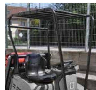
Защитен покрив за водача Защитният покрив за водача е задължителен при работа във високо стелажни складове. За осигуряване на сигурна и надеждна защита.
