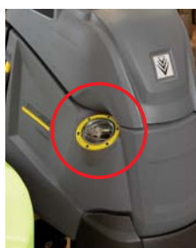
右側の給水口
