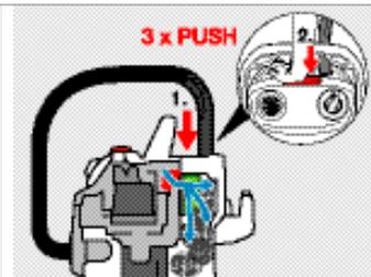
Der exklusive 3-in-1-Bügelgriff ermöglicht das komfortable Tragen des Gerätes sowie Öffnen, Schließen und Entleeren des Behälters.
