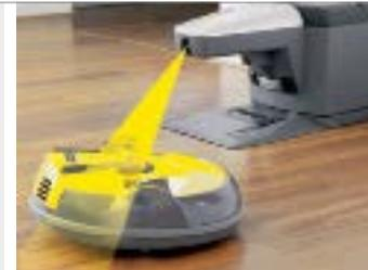
Die Navigation erfolgt per Infrarotstrahl. Der RoboCleaner findet selbstständig zur Basisstation zurück.
