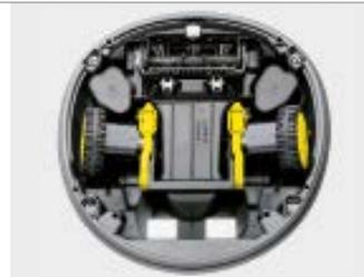
Der RoboCleaner reinigt mit einer Kombination aus Kehrwalze und Absaugung. Ein Sensor erkennt die jeweilige Schmutzintensität und passt das Reinigungsprogramm entsprechend an.
