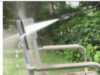
Durch Drehen am Vario Power Strahlrohr lässt sich der Druck je nach Reinigungsaufgabe stufenlos regulieren.
