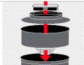
Durch das einzigartige Filtersystem, bestehend aus Flachfaltenfilter und Grobschmutzfilter, kann besonders viel Asche eingesaugt werden.
