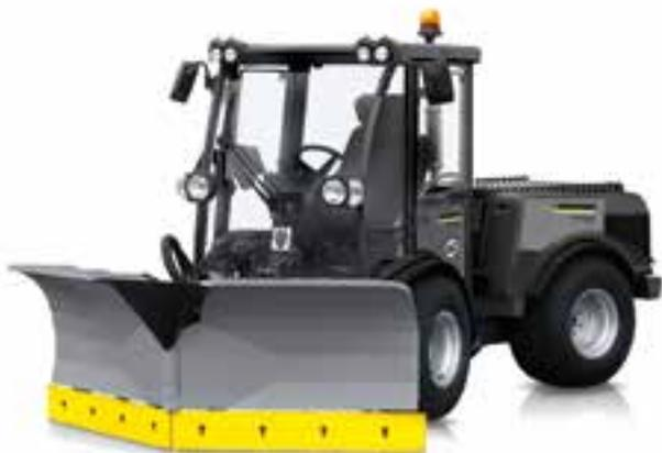
Die MIC 84 mit 5 Tonnen zulässigem Gesamtgewicht und 84 PS Leistung ist das ganze Jahr über universell einsetzbar. Dieses Arbeitsgerät bietet hohen Fahrkomfort, beste Ergonomie und Übersicht, viel Platz, geringe Lautstärke und Klimatisierung.
