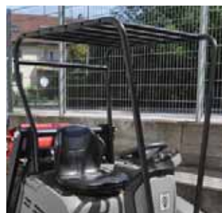
Fahrerschutzdach Fahrerschutzdach vorgeschrieben im Bereich von Hochregallagern. Für zuverlässigen und massiven Schutz.
