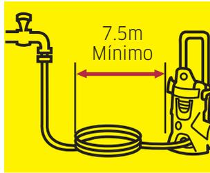
**2.** Utilice, como mínimo, 7.5m de manguera de entrada de agua. De esta manera, se prolongará la vida útil de la máquina.
