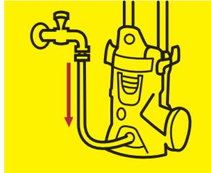
**2.** Conecte la máquina a la red de agua y abra el grifo pero **no** encienda la máquina.
