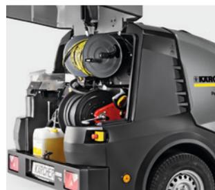
Langlebig: Dank verschleißfreier Technik, wie dem Umlaufbetrieb mittels Saugventilanhebung.
