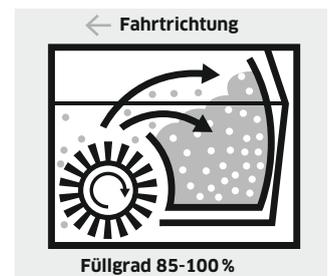
Effektiv: Kehrprinzip mit hoher Drehzahl füllt Schmutzbehälter bis zu 100%.
