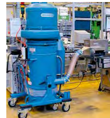
Entstauber in Fertigungslinien integriert
