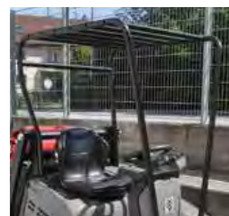
Fahrerschutzdach Das Fahrerschutzdach ist vorgeschrieben im Bereich von Hochregallagern. Für zuverlässigen und massiven Schutz.
