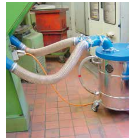
Geeignet zum Abscheiden von Funkenflug sowie von klebrigen, sehr leichten und problematischen Prozessmedien
