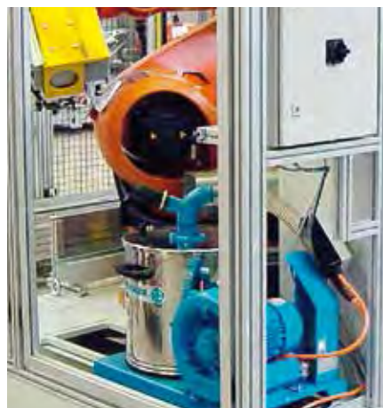
RA 40 integriert in Roboterzelle
