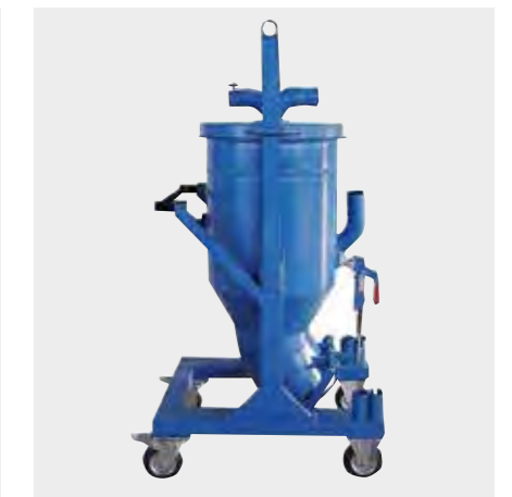
Vorabscheider 110 Liter mit Deckel, Kranösen, fahrbar, Staplertransport, Entleerung über Klappe, für Schüttgüter, Sand, Grauguss etc.
