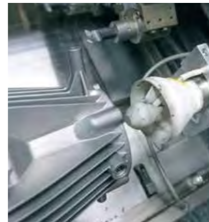
Düse im 3-D-Druck für besondere Absaugaufgaben
