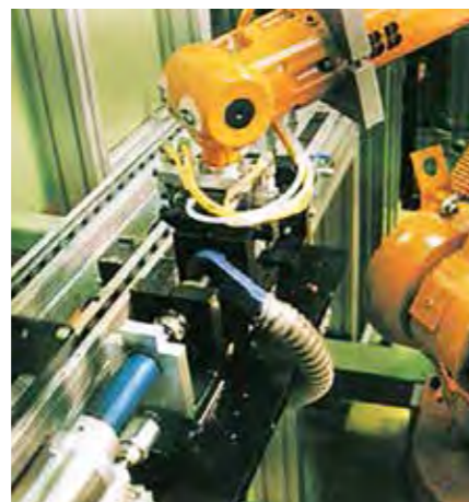
Ringler Saugdüse zur punktuellen Absaugung von Frässpänen
