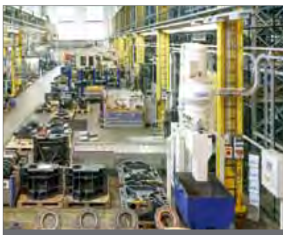
Centrální vysávací systém v konfiguraci pro více uživatelů v kovozpracujícím průmyslu
