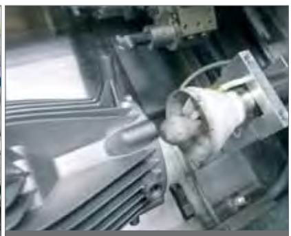
Hubice vytištěná 3D tiskárnou pro speciální úlohy vysávání
