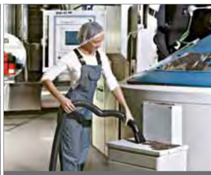
Vysávání zbytků potravinářských produktů během čištění v rámci údržby, například vysávání kávových zrn
