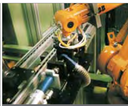
Saci hubice Ringler Kärcher Group pro přesné vysávání třísek z frézování
