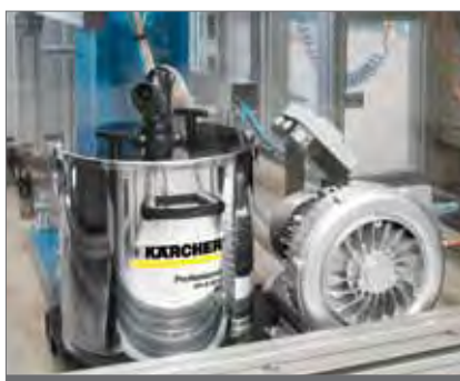
IVR-B 30/15 Me integrovaný do robotické buňky
