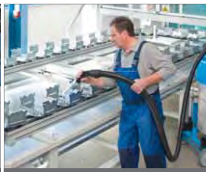
Vysávání třísek a chladicích kapalin pro účely údržby strojů a technologických celků
