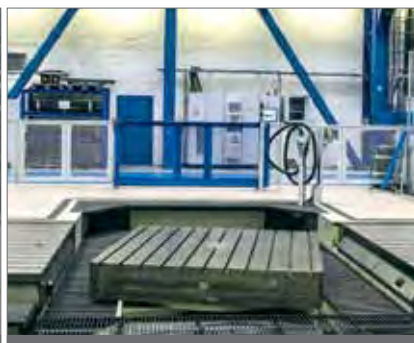
Vysunutý vysávací bod pro rozlehlé prostory obráběcích provozů
