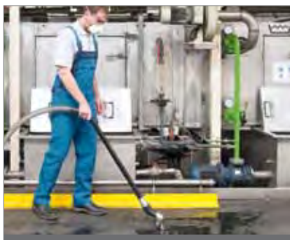
Vysávání kapalin, emulzí a olejů při čištění dílen
