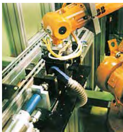
Vsesovalna šoba Ringler za natančno odsesavanje ostružkov pri rezkanju
