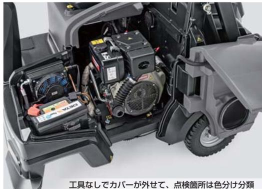
工具なしでカバーが外せて、点検箇所は色分け分類
