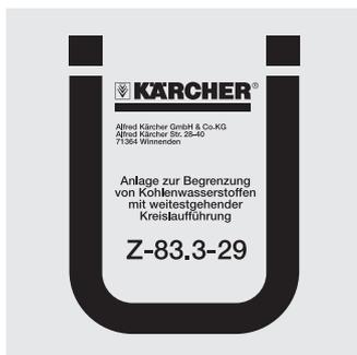
Die WRP 8000/WRP 16000 hat die DiBt-Bauartzulassung. Diese dient als Nachweis der weitestgehenden Kreislaufführung gemäß Anhang 49 der AbwV. Hierdurch wird das Genehmigungsverfahren bei Umweltbehörden deutlich vereinfacht.
