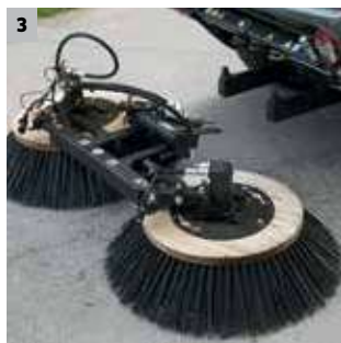
3 Gyorscserélő rendszer a készülékek szerszám nélküli cseréjéhez
