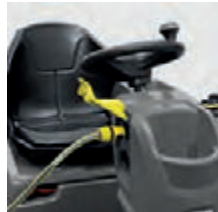
Funkce automatického plnění Časově úsporné a spolehlivé automatické plnění nádrže na čistou vodu.
