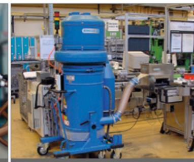
Entstauber in Fertigungslinien integriert
