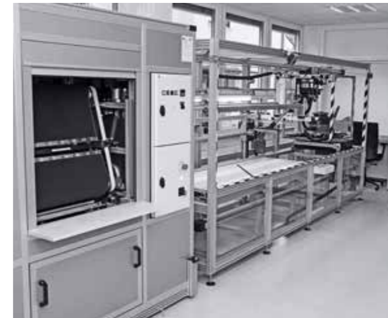
In het ErP-laboratorium voor droge stofzuigers kunnen het energieverbruik en de stofinname worden gemeten tijdens het reinigen van verschillende oppervlakken.
