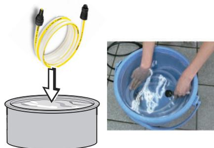
サクシオンホースをため水に沈めてください。ホース内に十分に水が入ってから先端部分を元通りに取り付けてください。
